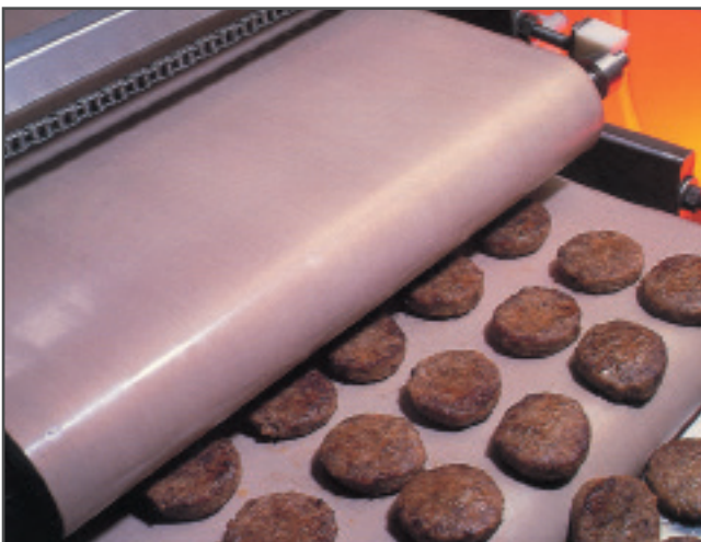
Bandas de tejido de vidrio con recubrimiento de teflón con propiedades antiadherentes y resistentes a temperaturas de hasta 260°C.
