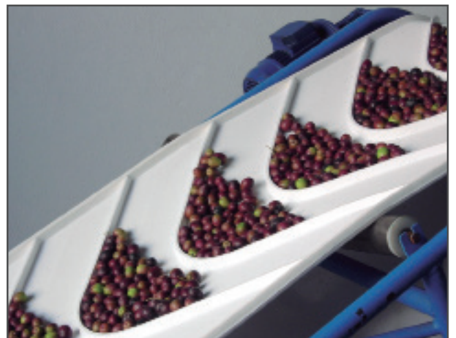
Bandas nervadas de PVC, para transporte de material a granel en artesa y/o inclinación.
