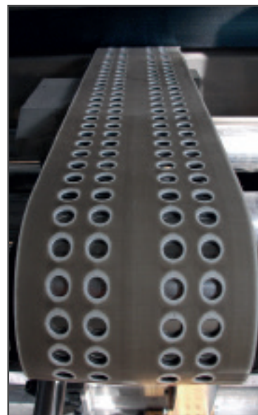
Correas planas hechas a medida , con agujeros, tacos, guías, recubrimientos, ...
