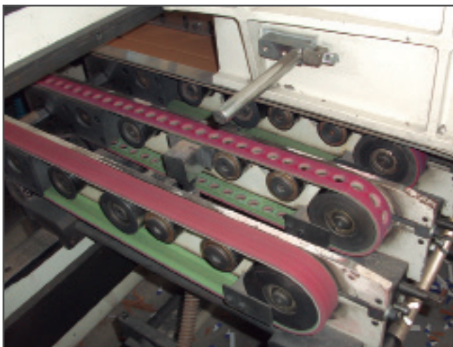
Correas planas con recubrimiento y/ o agujeros introdutoras de cartón.
